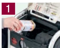
2本のカセットボンベを装填 スイッチを「運転」に合わせる グリップを引きエンジン始動
